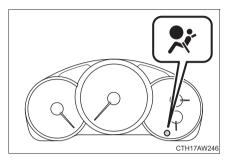
Un système de diagnostic continuellement contrôle la fonctionnalité du système d'airbag SRS (y-compris les prétensionneurs des ceintures de sécurité avants) lors de la conduite du véhicule. Le témoin lumineux du système d'airbags SRS montrera l'opération normale en s'allumant pendant environ 6 secondes quand le contacteur de démarrage est mis en position "ON".
